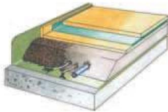
**Liaporfit auf Massivdecke bzw. Kellerbodenplatten**
