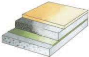
● gebundene Schüttung auf Massivdecke bzw. Kellerbodenplatten ...
