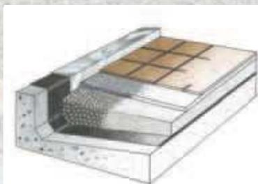
● Gefälleausgleich bzw. -dämmung unter Terrassen, Balkon, Flachdächern
