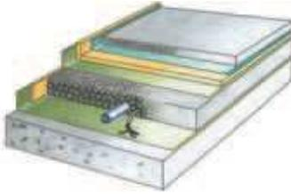
**Fußbodenaufbau auf einer Massivdecke mit gebundener Liapor-Schüttung (Liapor-Thermobeton)**
