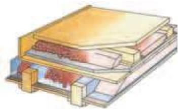
**Trockenaufbau bei Holzbalkendecke mit Zwischenbalkenverfüllung und zwischen Lagerhölzern mit Liapor 4/8 bzw. Liapor 8/16**
