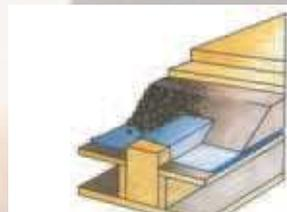
● belastbare Überschüttung der Balkenlage bei verschiedenen aufgebauten Holzbalkendecken
