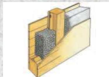
● Hohlraumverfüllung und Dämmung im Holzrahmenbau
